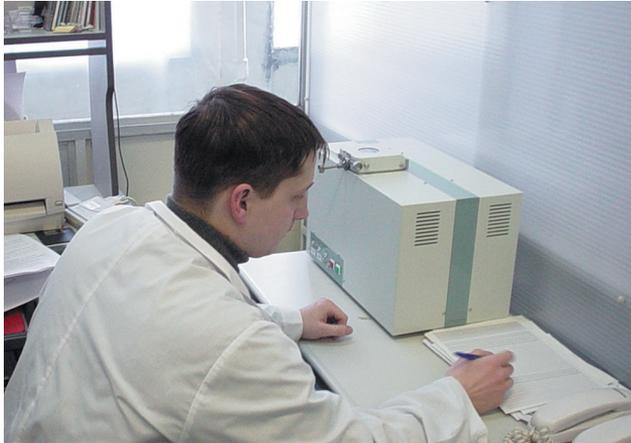
Рис. 1.1. Внешний вид рентгеновского дифрактометра РС-УАИ
