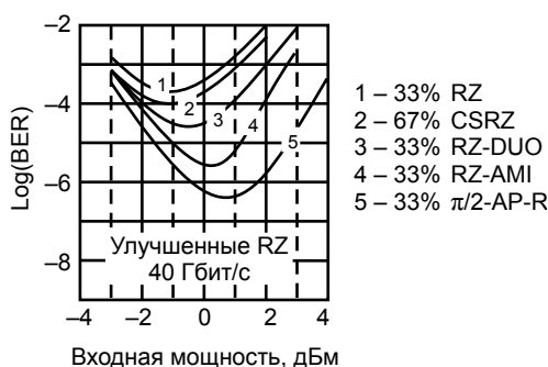
Рис. 2.22. Зависимость коэффициента ошибок (BER) от входной мощности в пролете (80 км). Линия из SSMF-волокон длиной 1980 км, улучшенный RZ-формат
