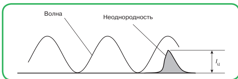
Рис. 2.14. Графическая иллюстрация ситуации, при которой радиоволна не отражается от цели
