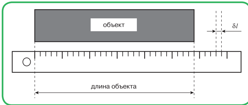
Рис. 2.3. Объяснение процесса измерения длины объекта
